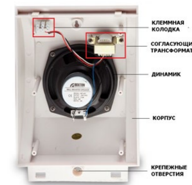
Рис. 5. Настенный широкополосный громкоговоритель ROXTON WP-06T (вид сзади)
