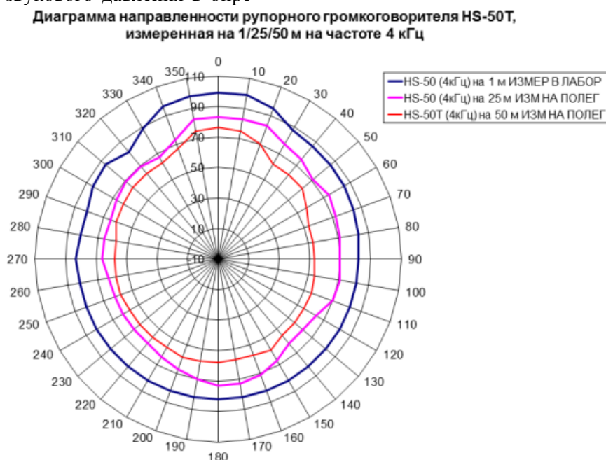
Рисунок 2. Диаграмма направленности рупорного громкоговорителя HS-50T, измеренного в лабораторных и реальных условиях на мощности 25/50 Вт.
